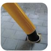
Das Modell Signal ist aus dem Modell Universal entstanden, das oben mit einer 250mm Bohrung versehen wurde. Hierin ist ein verzinktes Stahlrohr mit Ø60mm montiert. Am oberen Ende des Stahlrohres befinden sich 3 x M8 Schrauben, die die Montage und Befestigung eines Rohres mit dem Aussenmass Ø48mm ermöglichen. Es ist ausserdem möglich eine Aluminiumhülse mit Hochintensitätsrefl ektoren in verschiedene Farben zu montieren.
