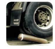
Kollisionsversuch mit dem Modell Standard. Die Räder des Lkw drehten am Poller durch, mit anderen Worten war der Lkw nicht in der Lage, den Poller völlig zu über-
